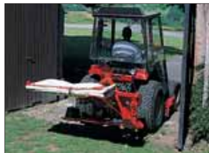
Der GMD 33 Scheibenmäher in Arbeitsstellung (Schutzvorrichtung hochgeklappt)
