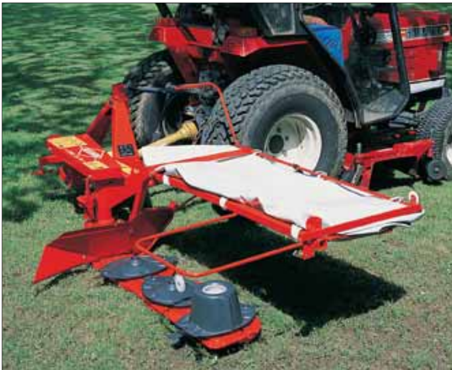
Der GMD 33 Scheibenmäher in Arbeitsstellung (Schutzvorrichtung hochgeklappt)
